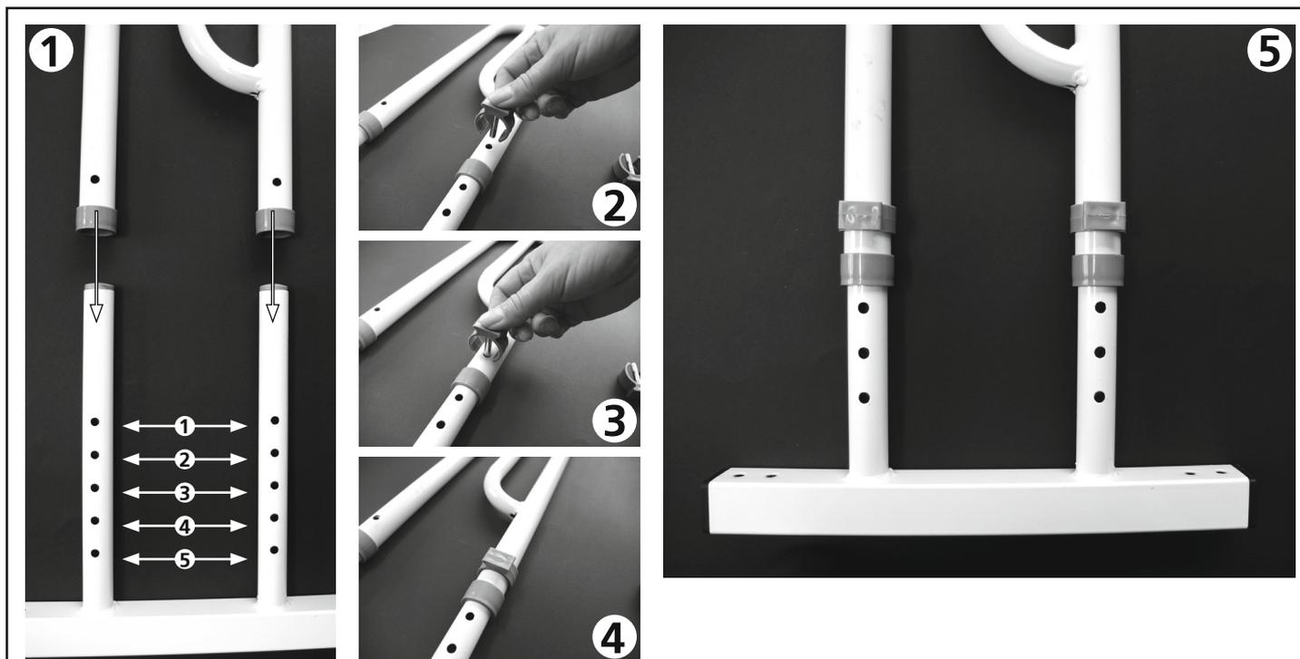
Ⓞ Legen Sie den rechteckigen Rahmen auf den Boden und stecken Sie den Haltegriff von oben auf bis zur gewünschten Position (5 Lochpaare für 5 Positionen) (1).
