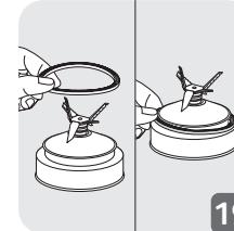
• Temizleme işleminden sonra yalıtım kapağını (**F3, O3**) bıçak ünitesine (**F1, O1**) düzgün bir şekilde yerleştirmeyi unutmayın (**Şekil 17**). Yalıtım halkasının bıçaklarla temas edip hasar görmemesi için dikkatli olun. Not: Yalıtım halkası doğru yerleştirilmediği takdirde blender haznesinin tabanı sızdırılabilir.
